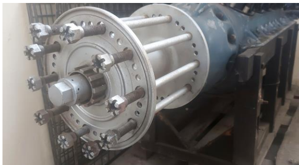
Flasques du moteur Hispano-Suiza du CMV
