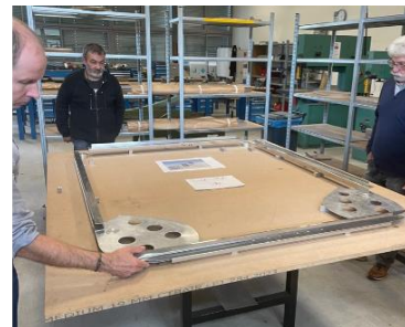
Cimblots pour assemblage des couples
