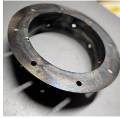
Ferrures partie centrale soudées (collerettes)
