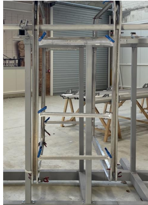
Pré assemblage final avec longerons et lisses
