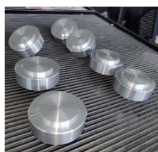
Cimblots pour assemblage des couples
