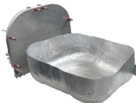
FORMAGE DU PROTOTYPE DU RECEVEUR DU LAVABO
