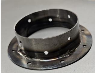
Ferrures partie centrale soudées (collerettes)
