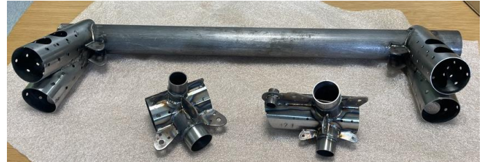
Ferrures partie arrière et l'étambot soudés
