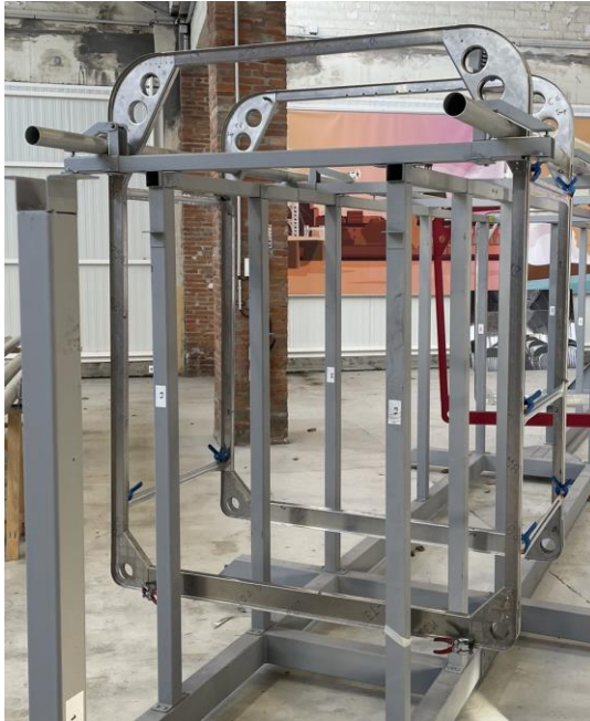
Pré assemblage final avec longerons et lisses
