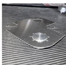
Cimblots pour assemblage des couples
