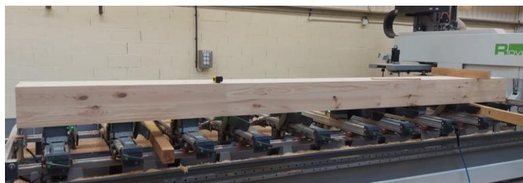
Madrier en position sur la machine 5 axes
