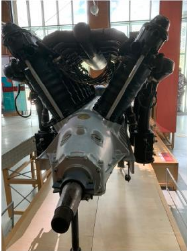
Moteur Renault du POTEZ 25 (Envol des pionniers)
