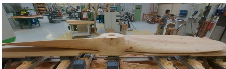
Usinage de l'hélice terminé (6 jours)
